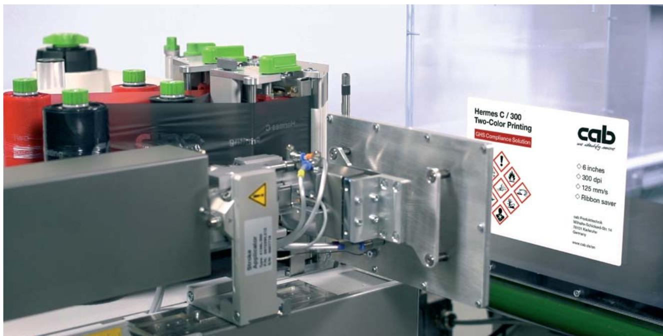
Avec ses deux blocs d'impression consécutifs, les étiquettes sont imprimées et distribuées en temps réel, sans perte de matière, même pour des étiquettes unitaires.
